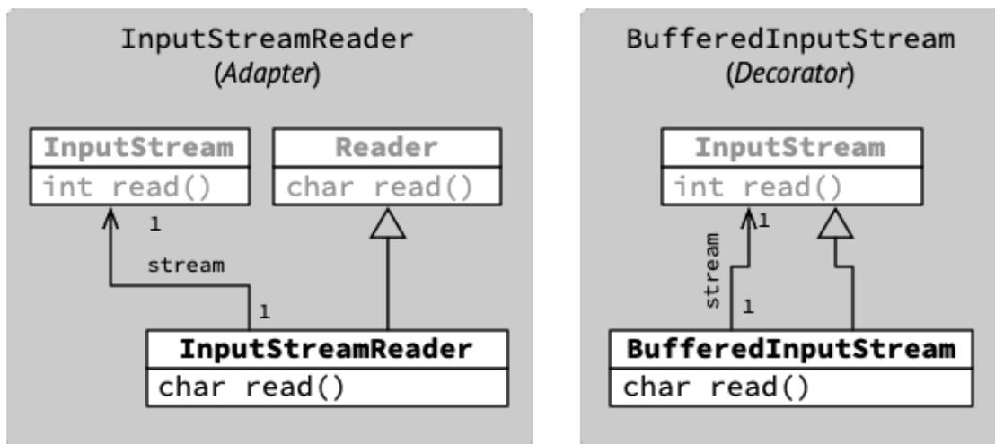
Une conséquence de cette différence est qu'il est possible d'empiler des décorateurs, mais pas des adaptateurs. Par exemple, l'extrait de code ci-dessous empile deux décorateurs (de type `BufferedInputStream` et `GZIPInputStream`) sur un flot de base de type `FileInputStream`.
