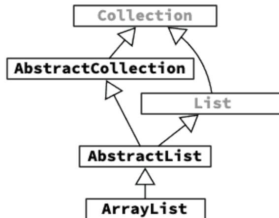
Dans cette hiérarchie, les classes `AbstractCollection` et `AbstractList` sont héritables et fournissent des mises en œuvre par défaut de la plupart des méthodes de `Collection` ou `List`. La classe `ArrayList`, quant à elle, est instanciable et représente la mise en œuvre des listes au moyen d'un tableau « redimensionnable ». Malheureusement, elle n'est pas finale, erreur historique qu'il est difficile de corriger actuellement pour des raisons de compatibilité.
