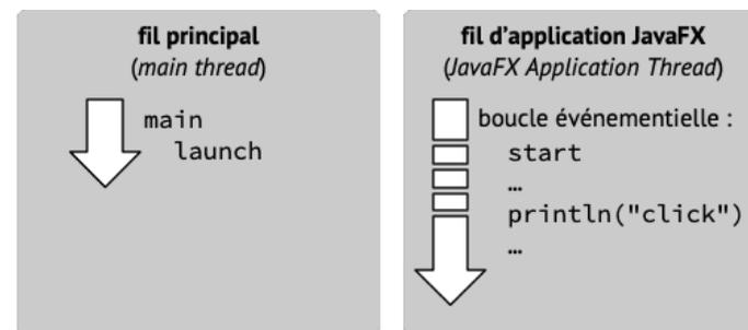
Fig. 4 : Fils d'exécution d'un programme JavaFX simple
