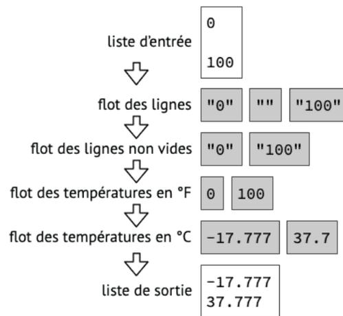
Fig. 1 : Flot de transformation de températures
